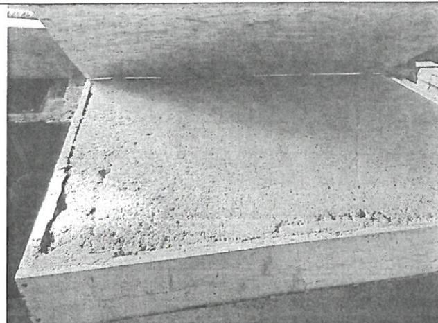
**Foto 2.** IZOLAȚIE CELULOZICĂ pusă în operă sub presiune, în tipar din lemn
